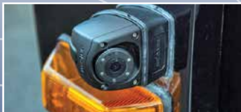
Sivukamera korotus palalla vilkun yläpuolella.
