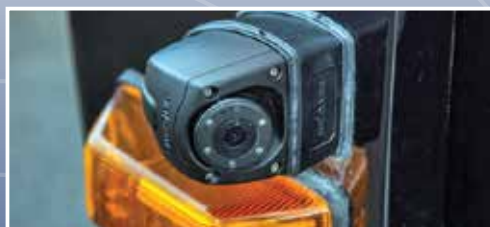
Sivukamera korotuspalalla vilkun yläpuolella.
