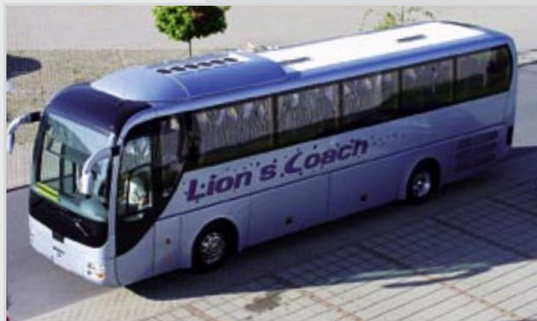
Aufdachklimaanlage EOS 400 für MAN Lion's Coach Roof-mounted air-conditioning unit EOS 400 for MAN Lion's Coach
